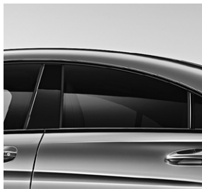
Wärmedämmend dunkel getöntes Glas ab B-Säule (840)
